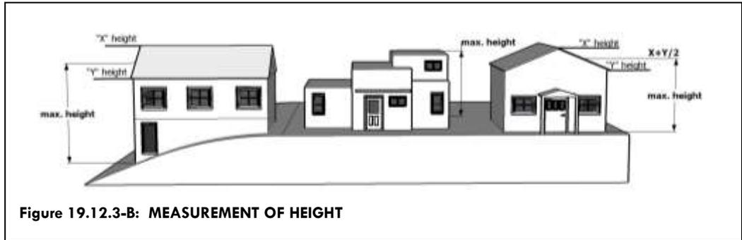
Figure 19.12.3-B: MEASUREMENT OF HEIGHT
